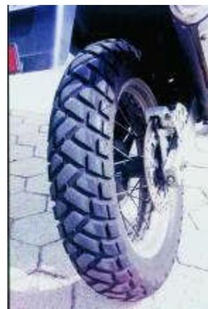
Verifique periodicamente a pressão com os pneus frios. A pressão correta dos pneus fará com que se aumente a sua durabilidade, a aderência, a estabilidade da motocicleta e o conforto do piloto. A calibragem recomendada pelo fabricante da moto já leva em consideração situações diversas de utilização, como calor, frio, piso seco, piso molhado, etc.
