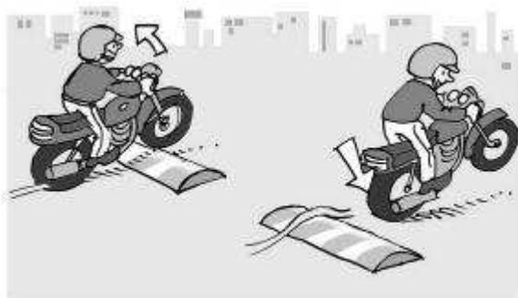
Ao passar pela lombada levante-se um pouco apoiando-se nas pedaleiras para suavizar a passagem. Caso a moto “decole” a roda traseira deve tocar o solo antes da dianteira, de forma a evitar a queda no “pouso”.
